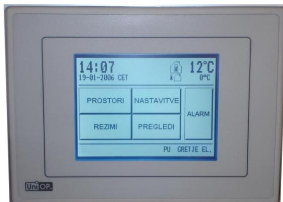
Slika 2: Menija za nastavitev na operatorskem panelu (touch screenu)
